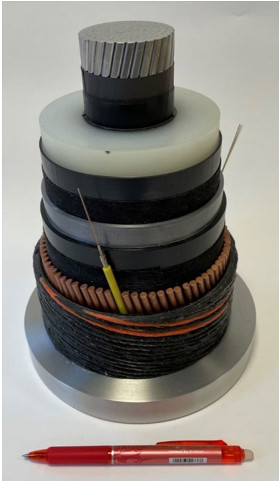
Figur 12. Exempel på uppbyggnad av en sjökabel.
